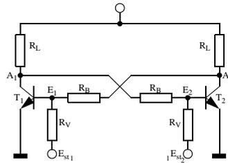
**Anfangszustand:** Bedingt durch Toleranzwerte der Bauelemente wird beim Anlegen einer Betriebsspannung  $U_b$  immer ein Schalter den "Aus-Zustand" und einer den "Ein-Zustand" annehmen. Durch Ansteuern aller Schaltwerke in gleicher Weise, kann man dafür Sorge tragen, dass alle Schaltwerke den gleichen Zustand annehmen.
