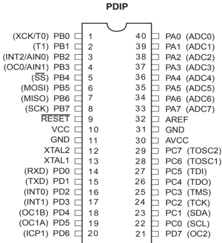
Aus **Kostengründen** ist nahezu jeder Pin **doppelt belegt**, die Konfiguration der gewünschten Funktion erfolgt durch die **Software**.
