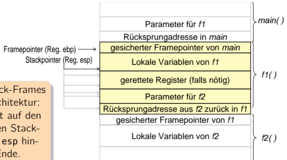
Aufbau eines Stack-Frames auf der IA-32-Architektur: Register `ebp` zeigt auf den Beginn des aktiven Stack-Frames; Register `esp` hinter das aktuelle Ende.
