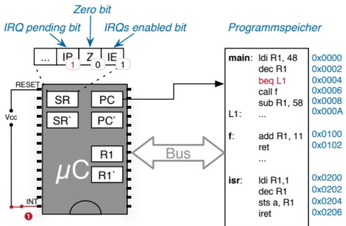
1 Gerät signalisiert Interrupt (aktueller Befehl wird noch fertiggestellt)
