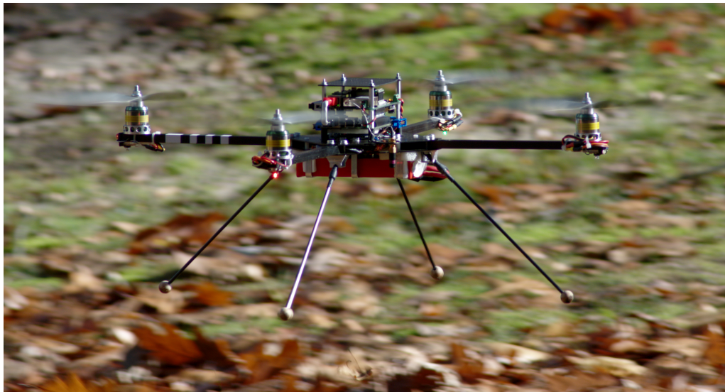
Abbildung 1.1: Der I4Copter im Flug: Deutlich zu erkennen sind die vier starren Motoren sowie der rote Akku. Darüber befindet sich eine Evaluationsleiterplatte für den Infineon Tricore und eine Leiterplatte mit der erforderlichen Sensorik.
