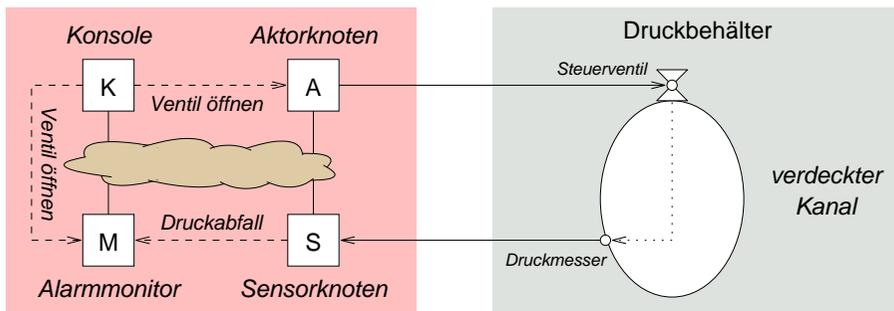
**M** überwacht den Druck im Druckbehälter  $\mapsto$  *kontrolliertes Objekt*
