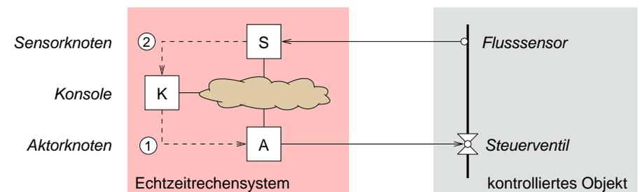
Der am Flusssensor gemessene und durch den Sensorknoten S zur Konsole K übermittelte Wert ② ist die End-zu-End-Bestätigung der zuvor von K über den Aktorknoten A an das Steuerventil versandten Nachricht ①.
