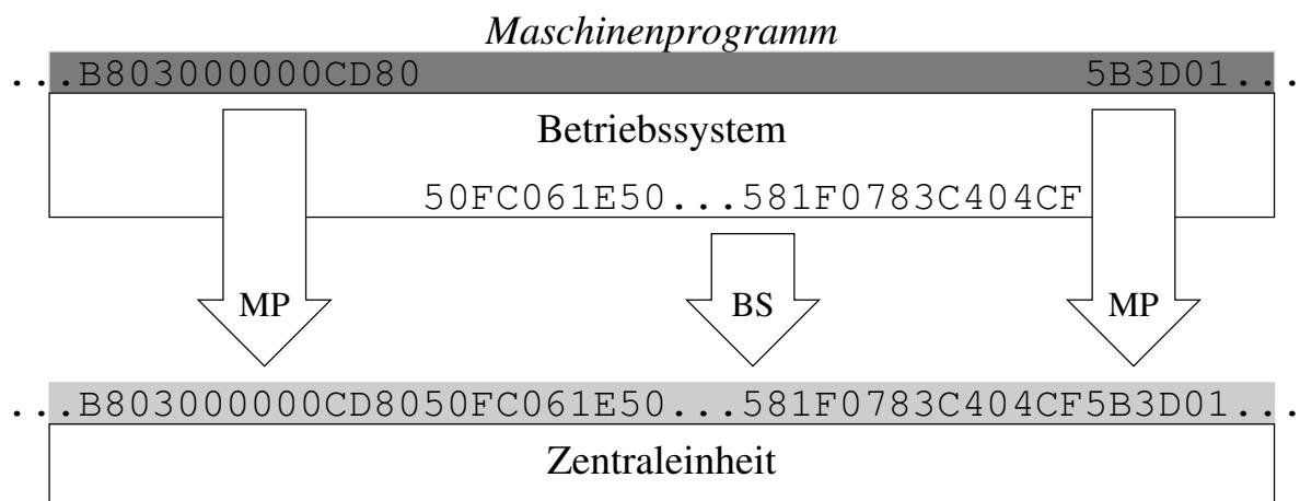
Eine bei Ausführung eines Maschinenprogramms vom *realen Prozessor* (Ebene<sub>2</sub>, Zentraleinheit) gestartete Behandlung einer Ausnahmesituation bewirkt — bildlich gesprochen — das „Einschieben“ von Befehlsfolgen jener Programme in den Befehlsstrom, die den *abstrakten Prozessor* „Betriebssystem“ (Ebene<sub>3</sub>) implementieren.
