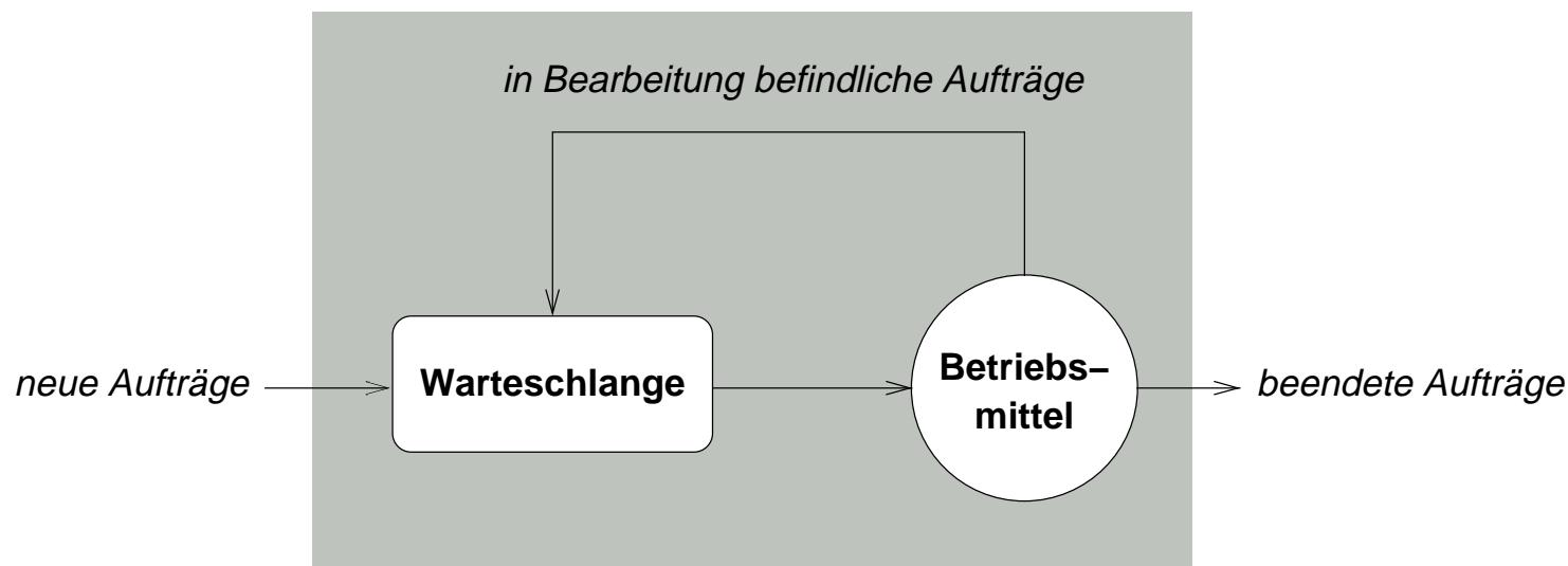
Ein einzelner Scheduling-Algorithmus charakterisiert sich durch die Reihenfolge von Prozessen in der Warteschlange und die Bedingungen, unter denen die Prozesse der Warteschlange zugeführt werden.
