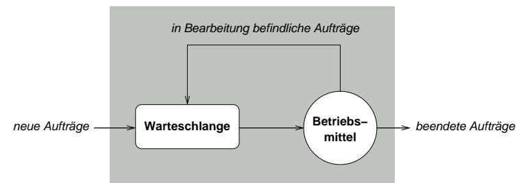
Ein einzelner Scheduling-Algorithmus charakterisiert sich durch die Reihenfolge von Prozessen in der Warteschlange und die Bedingungen, unter denen die Prozesse der Warteschlange zugeführt werden.
