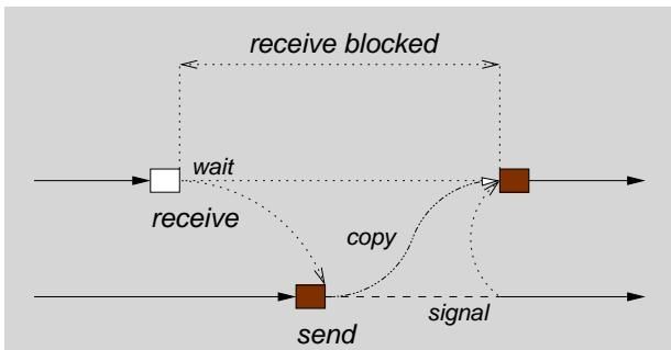
Der Empfangsprozess wartet im *receive* auf das *send* des Sendeprozesses, d. h., bis das für sein weiteres Vorankommen benötigte Betriebsmittel (☞ Nachricht) zur Verfügung steht und der Transfer der Daten vollzogen ist.
