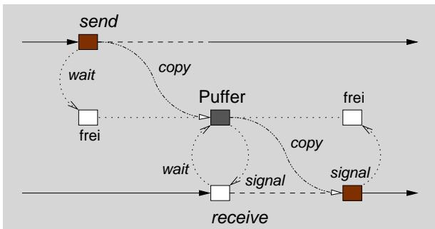
Send- und Empfangsprozess benutzen einen Puffer (*bounded buffer*) zum Datentransfer. In Ausnahmefällen müssen sie jedoch warten: der Sendeprozess auf ein wiederverwendbares Betriebsmittel, der Empfangsprozess dagegen auf ein konsumierbares Betriebsmittel.
