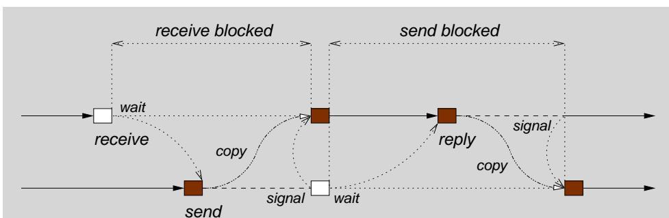
Der Server wartet im *receive* auf das *send* eines Clients, um eine Nachricht zu bearbeiten und ggf. mit *reply* zu beantworten.
