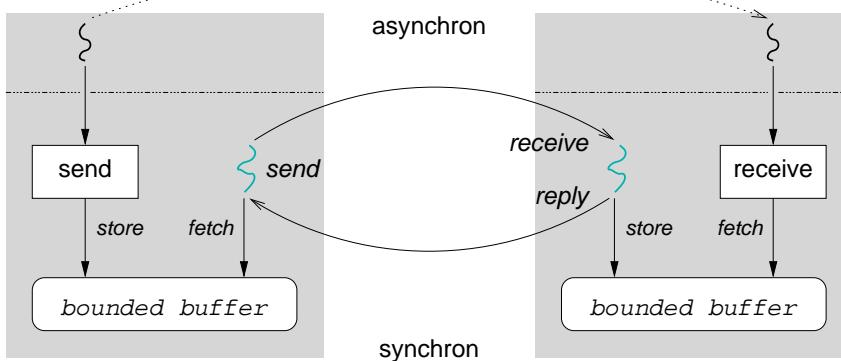
Asynchrone IPC ist durch „Hilfsfäden“ abbildbar auf synchrone IPC. Die Hilfsfäden kontrollieren eine *Pipeline*, die die Hauptfäden voneinander entkoppelt.
