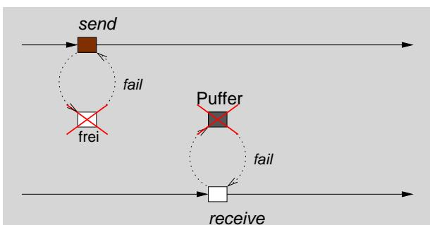
Send- und Empfangsprozess benutzen einen gemeinsamen Puffer zum Transfer der Daten. In Ausnahmefällen scheitert jedoch die Operation: das *send*, wenn kein Puffer mehr frei ist und das *receive*, wenn keine Nachricht zwischengepuffert ist.
