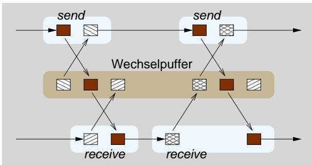
Der Sendeprozess bietet einen gefüllten Puffer an und erhält einen leeren zurück. Umgekehrt bietet der Empfangsprozess einen leeren Puffer an und erhält einen gefüllten zurück. Daten werden so ohne Kopiervorgänge von Sender zu Empfänger transferiert.
