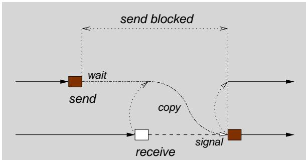
Der Sendeprozess wartet im *send* auf das *receive* des Empfangsprozesses, d. h., bis das zur Nachrichtenaufnahme benötigte Betriebsmittel (☞ Empfangspuffer) zur Verfügung steht und der Datentransfer vollzogen ist.
