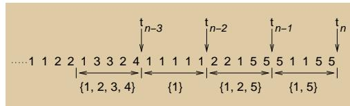
Die **Fensterbreite** deckt eine „feste Anzahl von Maschinenbefehlen“ ab, approximiert in Form von periodischen Unterbrechungen: sie ist bestimmt durch die **Periodenlänge**.
