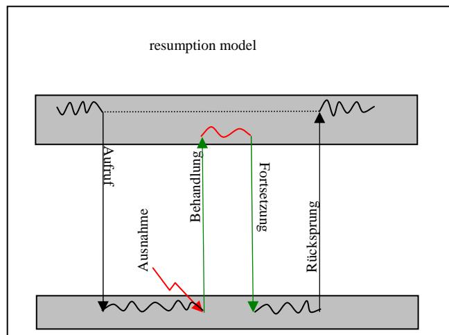
Die erfolgreiche Behandlung der Ausnahmesituation führt zur Wiederaufnahme der Ausführung des unterbrochenen Programms. Ein Trap kann aber ein Interrupt muss nach diesem Modell behandelt werden. Das unterbrochene Programm muss nach der Interrupt-Behandlung weiter ausgeführt werden.
