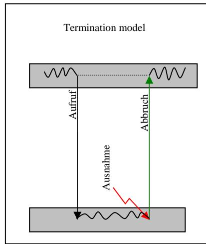
Die Ausnahmesituation konnten nicht behandelt werden, es wird ein schwerwiegender Fehler angenommen, der zum Abbruch des unterbrochenen Programms führen muss. Ein Trap kann, aber ein Interrupt darf niemals nach diesem Modell behandelt werden.
