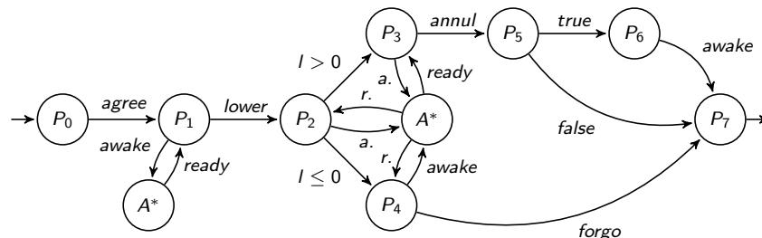
$P_0$   $P$  aufgerufen $P_1$  unverdrängbar, unbeweglich, aufweckbar $P_2$  Zeitsignal angefordert: *load* erniedrigt $P_3$  Zeitsignal verfügbar: nicht blockieren $P_4$  Zeitsignal nicht verfügbar: blockieren $P_5$  nicht aufweckbar, verdrängbar, beweglich $P_6$  „lost wake-up“ festgestellt $P_7$  Zeitsignal konsumiert:  $P$  verlassen
