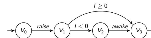
$V_0$   $V$  aufgerufen $V_1$  ein Zeitsignal wurde produziert:  $load$  wurde um einen Zähler erhöht $V_2$  wenigstens ein Faden müsste bereit sein, ein Zeitsignal zu konsumieren $V_3$   $V$  verlassen
