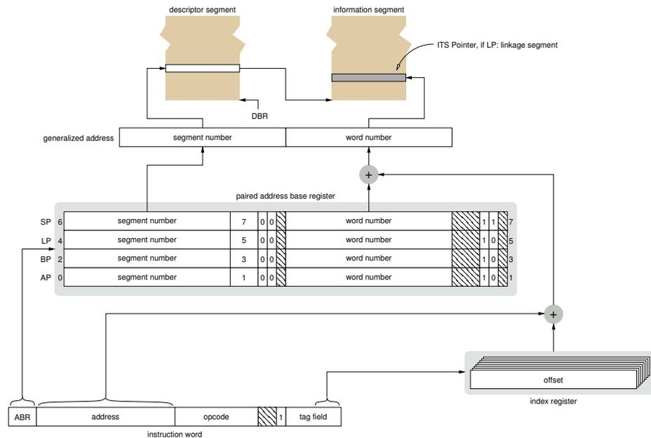
Exemplar eines Hardwaredatentypen zur **Zwischensegmentbindung** (*inter-segment linking*)  $\sim$  **dynamisches Binden**
