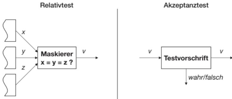
⚠ Zwei Testverfahren zur Fehlererkennung (vgl. [3, S.78 ff])
