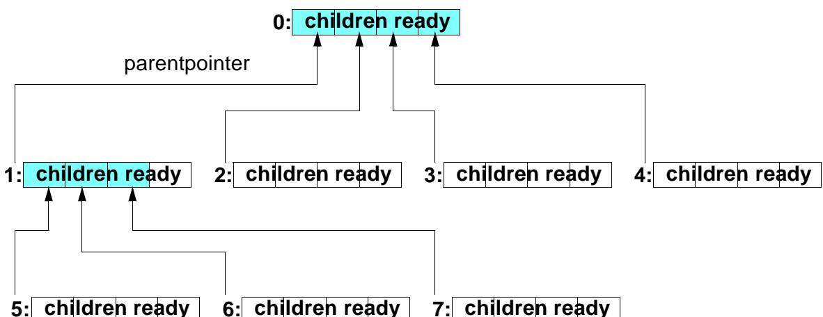
6. Mit Hilfe eines Aufweckbaumes mit Fanout 2 wird die Erlaubnis zur Weiterarbeit erteilt.
