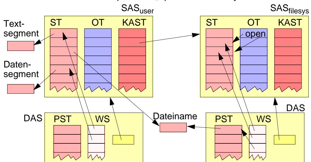
◆ für den Aufruf von „open“ wird ein neuer DAS erzeugt
