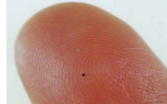
**$\mu$ Controller** von Sand-/Staubkorngröße, die über Radiofrequenztechnik miteinander kommunizieren [2]:
