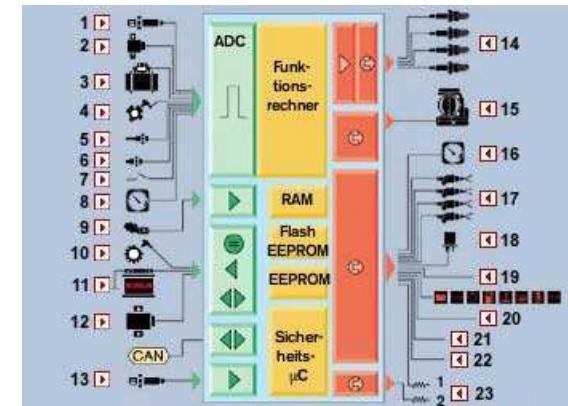
(Quelle: Bosch — Antriebsstrangnetz, Motorsteuerungsgerät und -anschlüsse)
