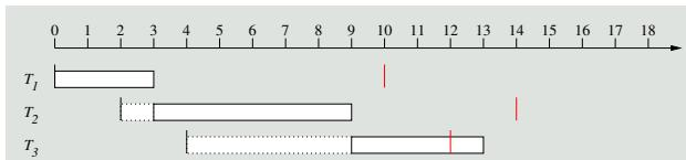
⚠ EDF versagt bei diesem System (Achtung: A7 außer Kraft<sup>2</sup>)
