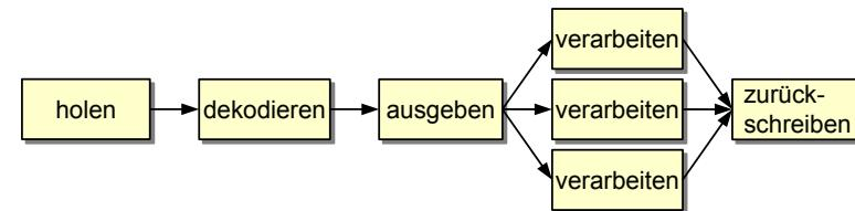
Im Idealfall werden alle Stufen immer benutzt, d.h. mehrere Befehle werden parallel ausgeführt. Wann soll geprüft werden, ob eine Unterbrechungsanforderung anliegt?
