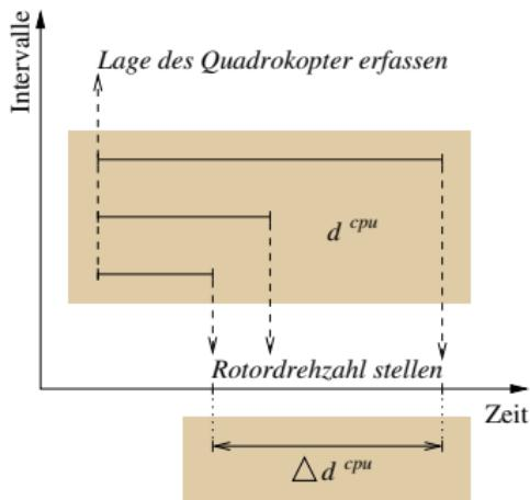
$d^{cpu}$  Auch bei konstantem Rechenaufwand zur Stellwertbestimmung variabel
