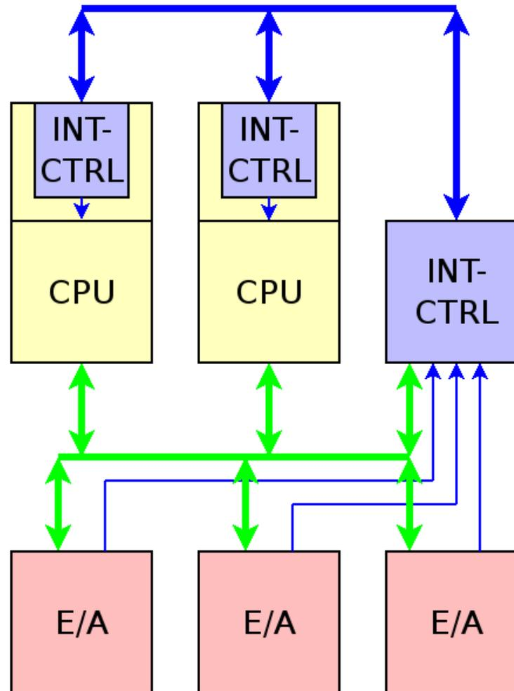
Interrupt-Controller sind selbständige, konfigurierbare Einheiten...
