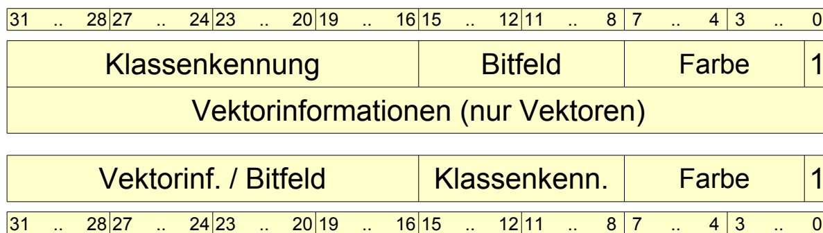
Abbildung 3.1: Objektköpfe auf einem 32-Bit-System
